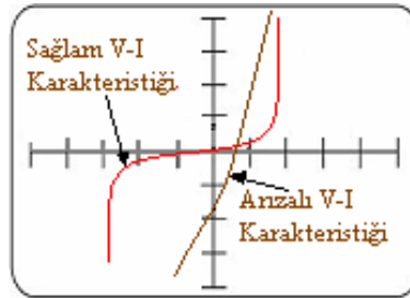
Şekil 3.1: Sağlam kart ile arızalı kartın karşılaştırması
